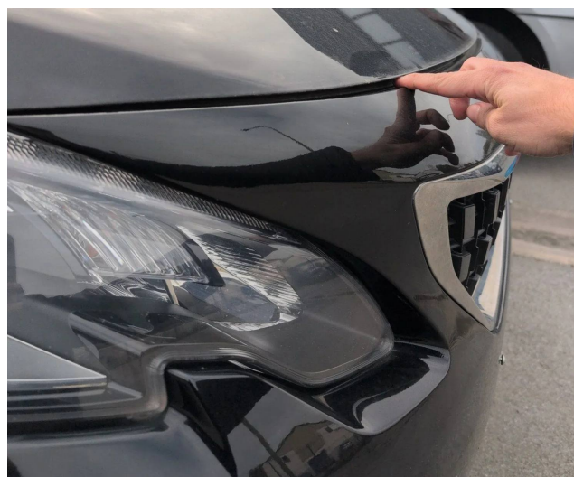
Photo 29 — Alignement des panneaux
